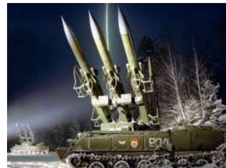
Пушковая установка 2П25 (ЗРК «КУБ») с тремя ракетами 3М9 в боевом положении
